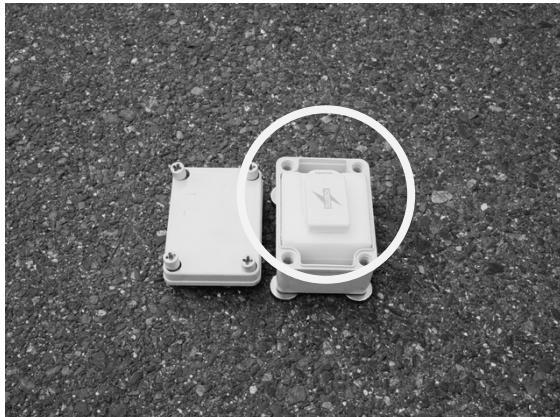
専用のタグケースをドライバーで開けて、タグを収納します。
