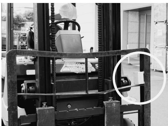
タグケースの磁石でマストに設置します。
