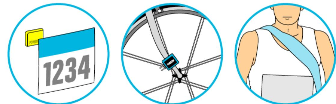
タスキに取り付ける場合、内側の端から 20~30cm の位置に横向きと縦向き（それぞれ異なる周波数）で少し離して固定します。（走っている時にタグの向きが変わらない様にしっかりと固定します）
